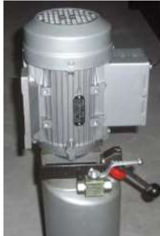
Рис 22 (насосная станция без контрольного блока)
