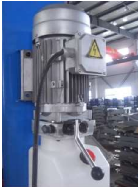
Рис 23 Насосная станция с контрольным блоком
