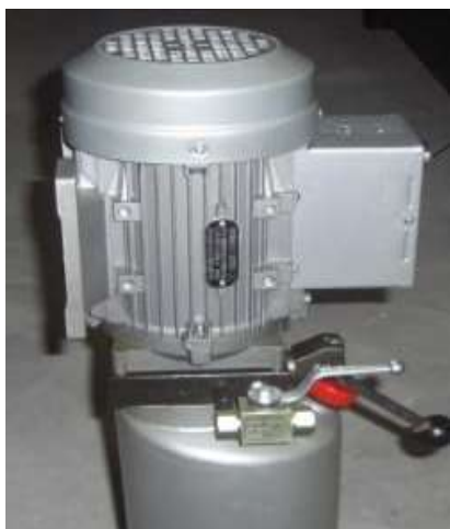
Рис 27 Стандартная сборка (насос без контрольной панели)
