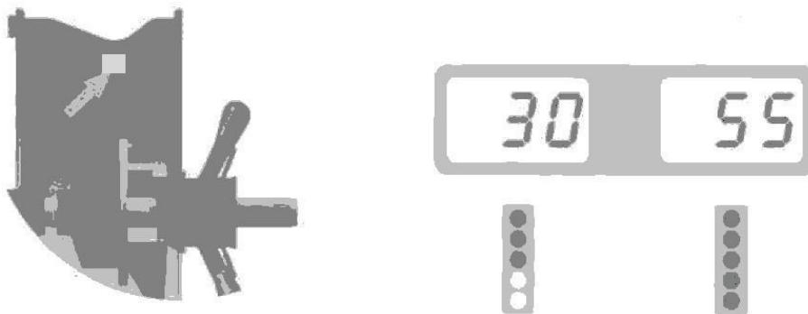
Рис. 6 4.2.6. Медленно поворачивайте колесо до тех пор, пока не включатся все индикаторы углового положения дисбаланса с левой стороны обода. Закрепите груз в положении на 12 часов ( $9H=off$ ) или в положении на 9 часов ( $9H=On$ ) (рис. 7).
