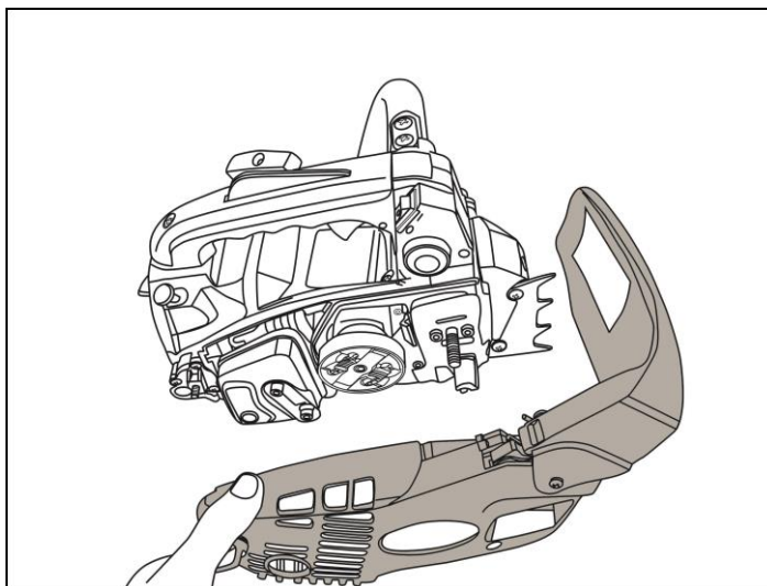
Рис. 2 Снятие прижимной крышки шины
