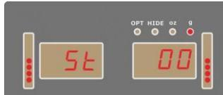
На табло значения дисбаланса отображается результат измерения статического дисбаланса. Вращайте колесо, когда обе вертикальные шкалы индикации углового положения дисбаланса будут полностью подсвечены, установите балансировочный груз в положении на 12 часов с любой стороны обода.
