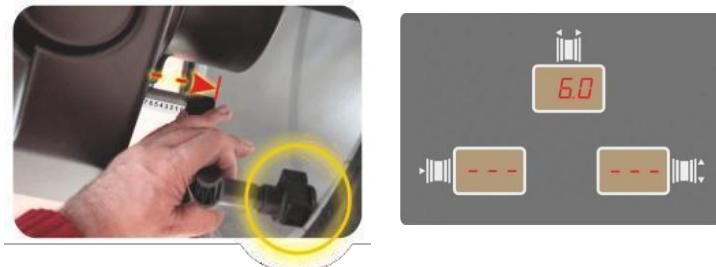
Установите измерительную штангу в исходное положение, на табло A и D отображаются требуемые значения параметров.
